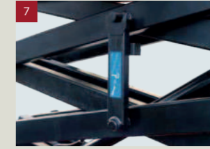
Destek Kolları: Operatörün tamir veya bakım işi yaparken korunmasını sağlayan destek kolları
