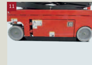
Devrilme Önleme Sistemi: Makine 6.5ft'den daha yüksek kaldırıldığında, bu sistem otomatik olarak devrilme koruması sağlar ve düz olmayan zeminde yürürken makinenin devrilmesini önler.
