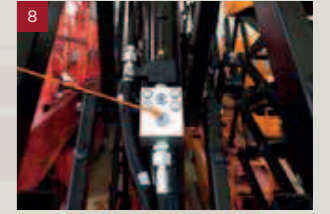
Patlamaya Karşı Dayanıklı Vana: Yağ borusu sızdığından makinenin düşmesini önlemek için
