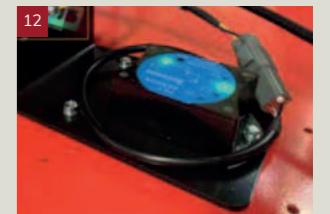
Açı Sensörü: Eğimde kaldırma ve hareket ettirme işlemi sırasında, sensör otomatik olarak makinenin durumunu değerlendirir. Eğer açı belirlenen açıdan daha büyükse, operatörü uyarı için bir alarm sesi çıkaracaktır.
